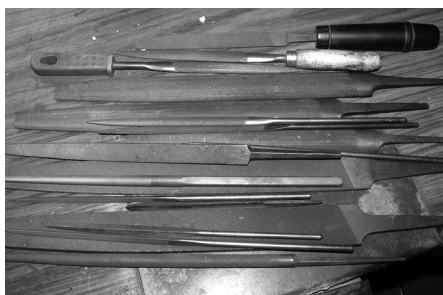
Figura X. Limas planas, triangulares, cónicas y media caña de distintos tamaños (21)
