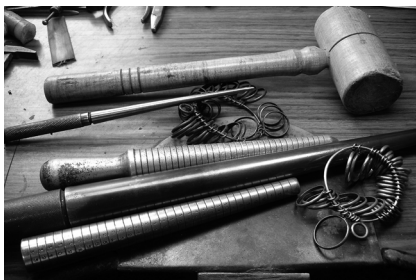
Figura V. Anilleros graduados (4), palos de medir (25), lastra y lastrín redondeado (19)
