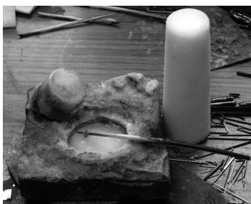
Figura VII. Piedra de Bórax (7), Borrajera (8), pincel para el agua de soldar (28)
