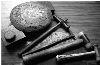
Figura XVIII. Mazos (3) de metal y caucho, martillos remachadores (22), plomo para embutir (29), tas de golpeo (36)
