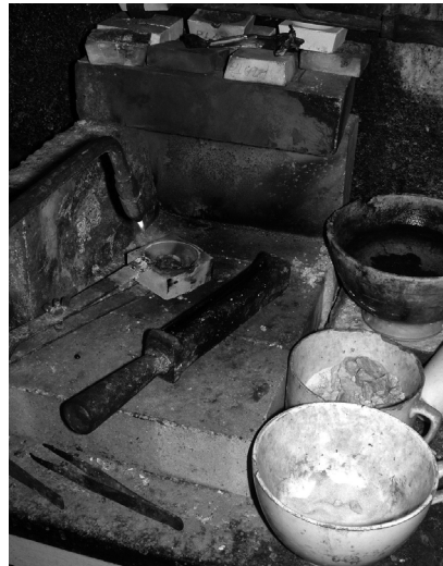
Figura XIV. Fundición: mesa (24) provista de crisoles (12), portacrisoles (39), pinzas, ladrillos refractarios (18), rallera (13), soplete (34), recipientes para la dilución de sal nitro con bórax y el blanqueamiento con agua y ácido sulfúrico (vitriolo)
