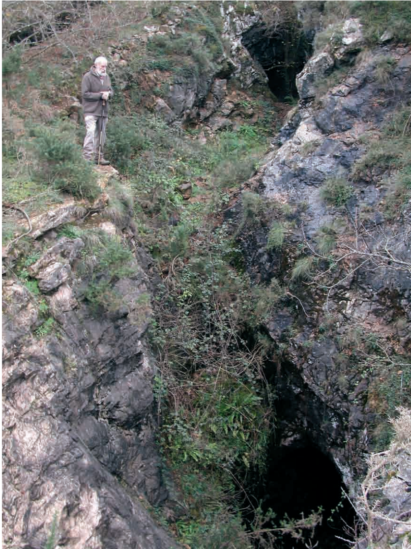
FIGURA 4. Vista parcial de los «Pozos de arriba», arranque de las labores del XIX que dieron con la minería prehistórica. La explotación moderna siguió la veta que, en fuerte pendiente, encaja en la masa caliza afectada por la actividad cárstica (Foto de Ángel Villa Valdés).
