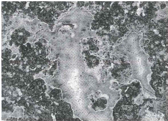
FOTO 3. Aspecto microscópico de silcreta del Terciario continental de Treviño donde se observan abundantes cementaciones de calcedonita (zona limpia de relictos). Anchura del campo: 3 mm. Luz normal.
