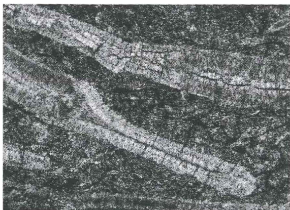
FOTO 6. Detalle microscópico de Nummulitidos del género Operculina perteneciente a sílex del Terciario marino de Urbasa. Anchura del campo: 3 mm. Luz polarizada.
