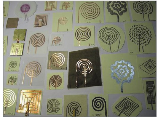
Fig. 10 Ejemplo de bobinados de cobre para la creación de altavoces de papel.
