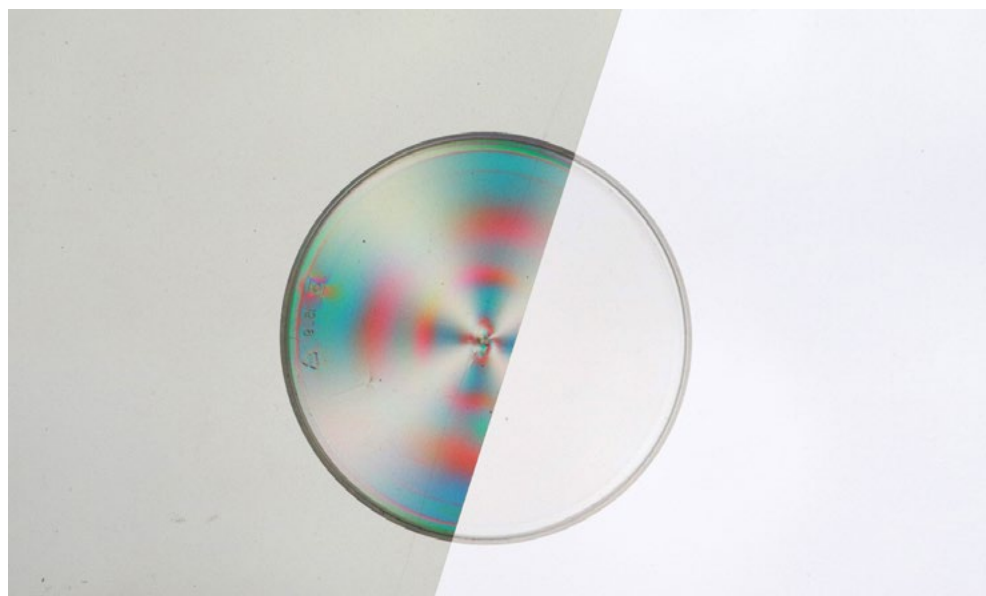
Fig. 3. Fotografía de la aparición de los colores y patrones de interferencia generados por tensiones internas en una tapa de plástico, comparando su apariencia con y sin luz polarizada, 2025. Archivo digital. Fuente: elaboración propia
