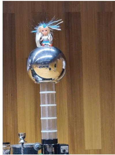
Figura 7. Demostración de cómo funciona la electricidad estática.
