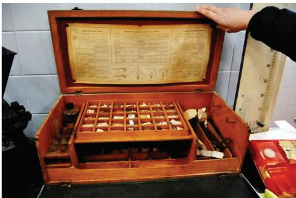
Foto 21. Laboratorio portátil de química, con instrumental recipientes y muestras.
