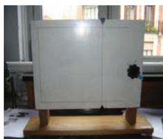
Apreciación visual de las dimensiones de un cuadrado, relacionando la longitud vertical con la horizontal. Consiste en un tablero rectángulo, sobre soporte, en posición vertical, que en su cara tiene grabadas tres líneas fijas, las dos horizontales y la vertical izquierda, y una línea movable, la vertical derecha, que se acciona con un mando con la intención de fijarla en el punto exacto donde forme el cuadrado perfecto con las otras tres líneas fijas.
