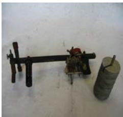
El aparato consta de una barra de metal, que tiene en el extremo un mecanismo para marcar con un lápiz negro sobre papel. Expresa la medida del esfuerzo y se mueve a cada impulso y tracción del dedo del alumno, cuyo antebrazo queda sujeto con firme correa. Mide intervalos de tiempo con gran precisión. Conjunto de nueve pesas en forma de disco, de grosores diferentes.
