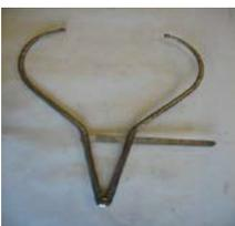
También denominado antropómetro. Consta de una escala graduada curva y dos ramas. La escala graduada está colocada entre las dos ramas; una tuerca fija la escala, manteniendo la medida. Junto a la escala métrica (de 0 a 25) se encuentra grabado "E. ZIMMERMANN. LEIPZIG".
