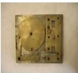
Consiste en un tablero formado por varias piezas metálicas, algunas de ellas móviles y giratorias. Una de las piezas es de color negro, y si se mueven las otras piezas de la forma correcta, la pieza negra se puede extraer. La prueba consiste en que el alumno coloque las piezas de forma que su posición permita la salida de la pieza negra, libremente. Se contabiliza el tiempo. Inventario 1946-1947.
