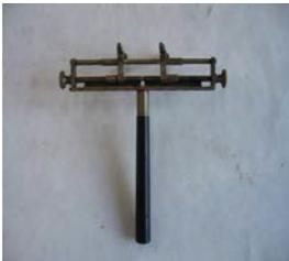
Es una herramienta para medir la agudeza táctil. Formado por un mango y varias piezas perpendiculares, con dos reglas simétricas de 0 a 4 cm. Sobre las reglas se sitúan dos piezas que se pueden mover con unas tuercas laterales; estas piezas tienen forma alargada, que se estrecha en la punta. Se trata de ir abriendo el compás hasta que la persona sienta los dos pinchazos y con la regla medir la distancia entre las dos piezas. “E. ZIMMERMANN. LEIPZIG”.
