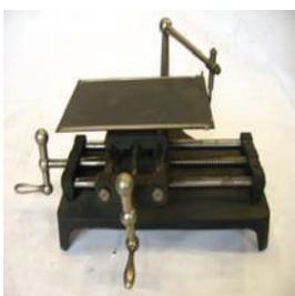
Dos tornos, que mueven una plataforma sobre la que va sujeta una hoja de registro de papel, con una gráfica que lleva un camino señalado, sobre el cual el alumno habrá de ir deslizado un estilete cargado de tinta, que dejará su marca en el trazado del camino, combinando el movimiento y manejando los dos tornos a la vez. Se anota el tiempo empleado y la calidad de precisión del recorrido.
