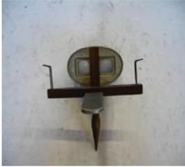
Gafas estereoscópicas. Permite ver imágenes en relieve. El aparato consta de unas gafas con paredes de metal con dibujos y dos lentes. Estas gafas van unidas a una pieza de metal sobre la que se sitúa una de madera; es en esta última donde se sitúan las imágenes estereoscópicas.
