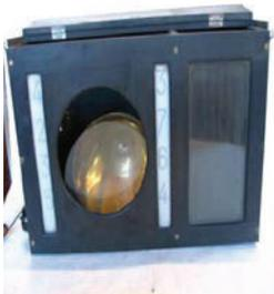
Apreciación de la resistencia al deslumbramiento, agudeza y recuperación visual. Se compone de un faro con dos franjas de cristal a cada lado, con números pintados en negro. En el lateral derecho, tiene los mandos de las pruebas.
