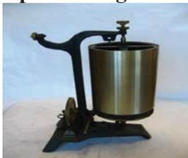
Es un tambor de aluminio movido por motor eléctrico que registra y cuenta con un regulador de velocidad. Está formado por una base que lleva en la parte inferior un sistema de poleas. Unida a la base, hay un brazo que sostiene por arriba y por el tambor de 20 cm. de diámetro.
