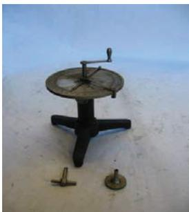
Está formado por una base de tres patas sobre la que se sitúa un disco plano de color plateado, con una escala de 0° a 360°. El disco tiene dos radios, que se pueden fijar, y una aguja que arrastra estos radios. El aparato se puede descomponer en varias piezas
