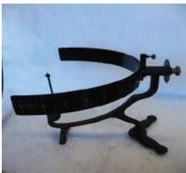
Para determinar la amplitud del campo visual de cada ojo. Está formado por una base que sostiene un semicírculo de metal con escala simétrica de 0° a 90°. Delante de esta escala, hay un disco con escala circular simétrica de 0° a 180°, de forma que al girar el arco una aguja marca los grados en la escala circular. Inventario 1950-1951.
