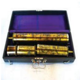
Son aparatos que amplifican las frecuencias de los sonidos. Son cuatro resonadores de diferente tamaño, de forma cilíndrica, que por un lado son abiertos y por al otro acaban en una pequeña boquilla. Tiene inscrito en la tapa “Kontinuirlicher Resonatoren-Apparat nach Schaefer. E. ZIMMERMANN, LEIPZIG-BERLIN”.
