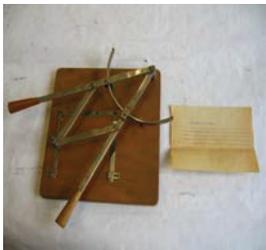
Un tablero con dos brazos articulados que, en combinación motriz, mueven un estilete, cargado de tinta, que se ha de conducir por la línea marcada en una lámina que se sujeta al tablero con unas presillas. Se toma el tiempo y la calidad de ejecución, anotando las salidas de pista, que restarán medio punto al tiempo.
