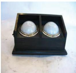
Caja de madera en la que hay dos focos cuya intensidad luminosa se gradúa a voluntad. En el lado izquierdo hay un interruptor de encendido/apagado. En el lado derecho hay un botón para graduar la intensidad del foco. Se conserva la hoja de instrucciones de este aparato.
