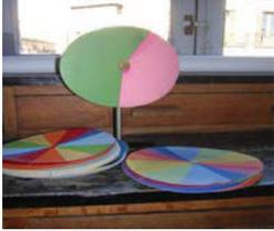
Aparato giratorio y conjunto de 21 discos de diversos colores. Los discos se hacen girar, de forma que se puede observar la suma de los colores. Algunos de los discos permiten unirse de dos en dos, observándose distintas combinaciones. El aparato está formado por un soporte de tres pies y una pieza vertical que finaliza en un dispositivo para colocar los discos y poder girarlos.
