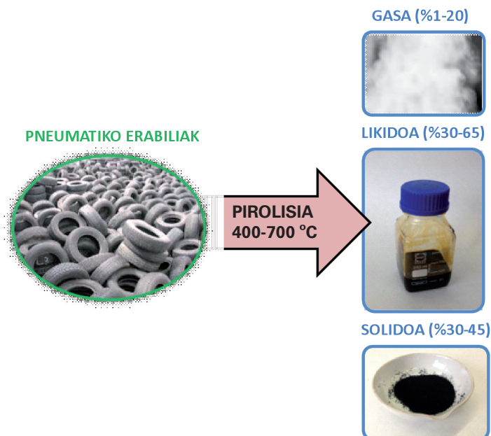
2. irudia. Pneumatikoen pirolisi prozesuaren eskema.
