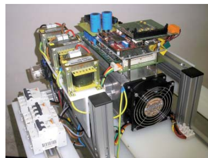
(a) MCaren kontrolerako FPGAn inplementatu diren coreen bloke-diagrama (b) 7,5 kW-ko MCaren prototipoa
