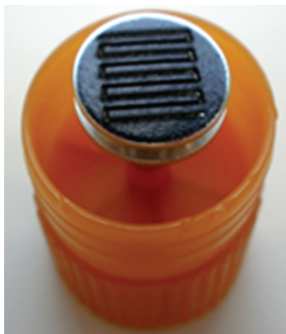
4. irudia. Laserrak karbonozko zinta itsasgarrian sortutako sigi-saga erako patroia.
