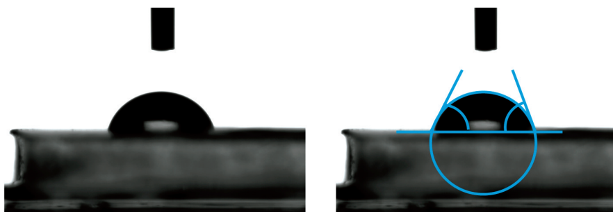
4. irudia. Ukipen-angelua eta prozesaketa PMMA gainazal batean.
