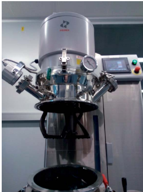
2. irudia. Elektrodoen suspentsioak prestatzeko nahasgailu planetarioa.
