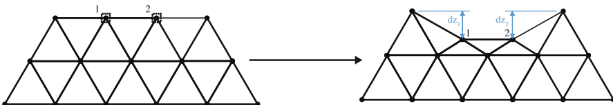
8. irudia. Nodok lurruntze-tenperatura gailentzean esperotako itxura aldaketa.
