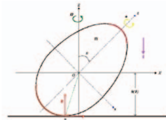
12. irudia. Arrautza biratzailea gainazal lauaren gainean eta indarrak.
