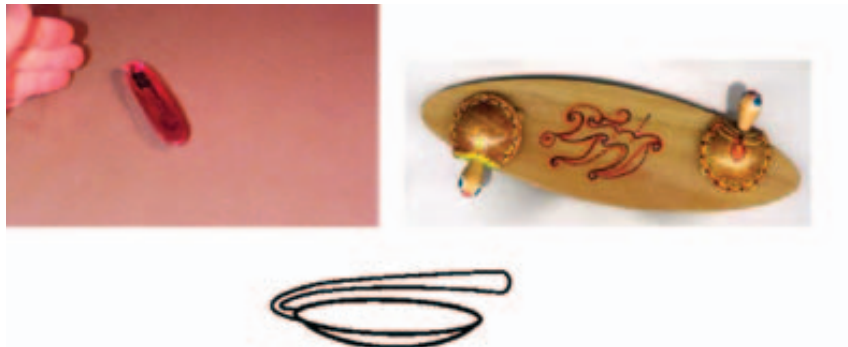
11. irudia. Plastikozko rattleback-a, diseinu errusiarra eta koilararekin egindakoa.
