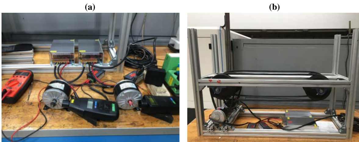
11. irudia. (a) Takometroak eta (b) banku multzoaren antolaketa.
