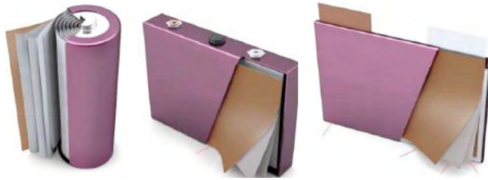
1. irudia. Zelula-geometria ohikoena: (a) zilindrikoa, (b) prismatikoa, eta (c) pouch motakoa [6].
