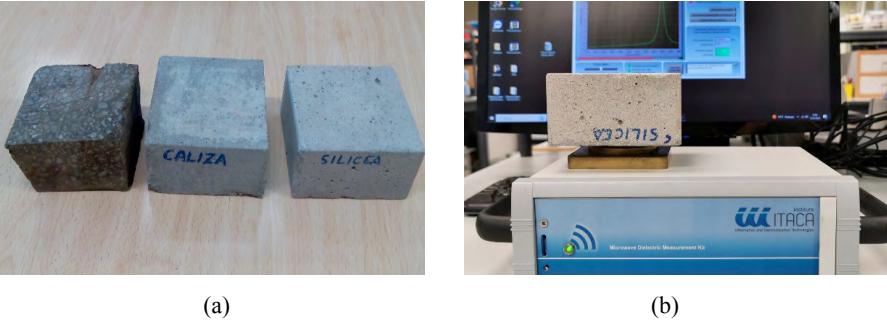
7. irudia. (a) Asfalto- eta mortero-probetak (kareharri-agregakina eta silize-agre-gakina) eta (b) haien propietate dielektrikoen neurketa (b).
